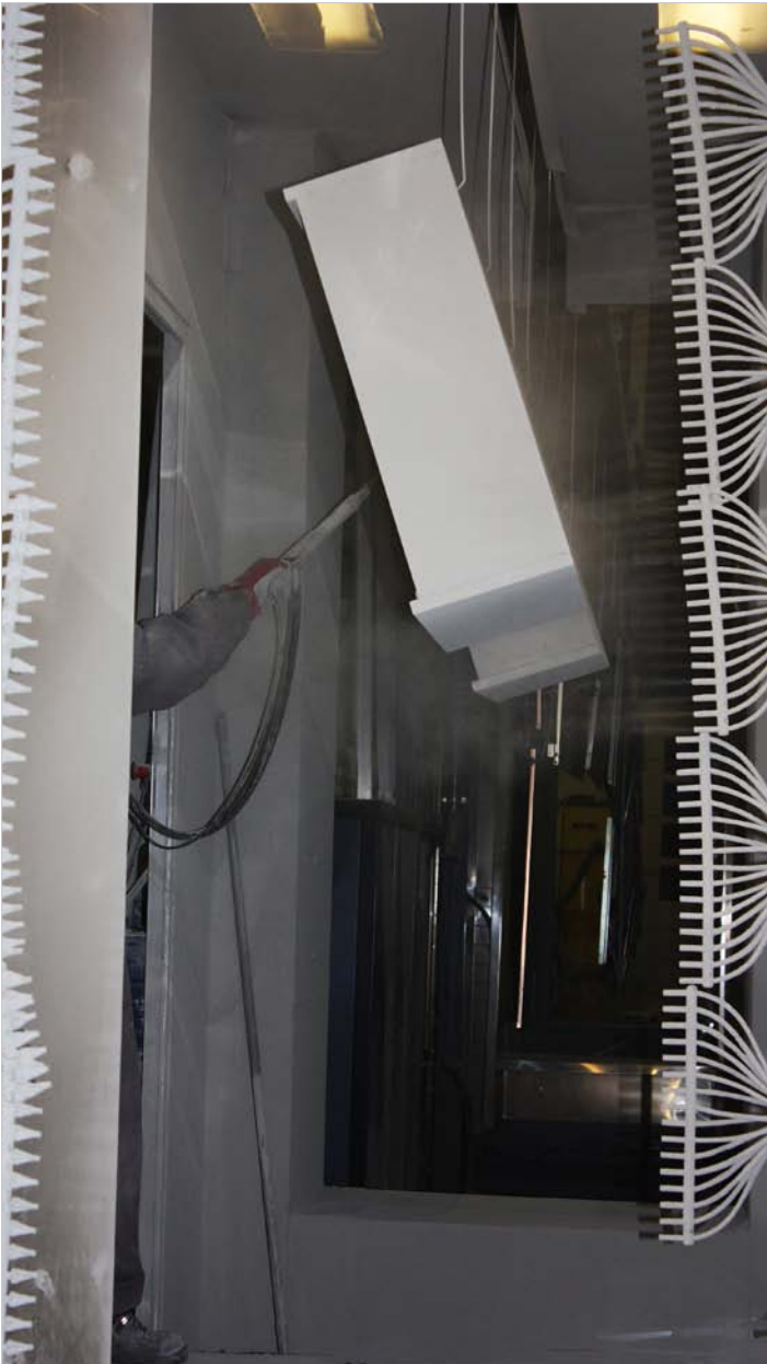
Jauhemaalauksasemalla vaikeasti tavoitettavat kohdat ruiskutetaan käsin.
